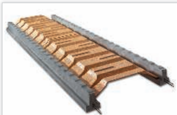
RECTOR, Rectolight. Wypełnienie: panele stropowe z drewna prasowanego. Długość elementu: 120 cm, zastępuje 6 pustaków. Wysokość stropu [cm]: od 16 do 26. Masa: 1 m 2 stropu od 190 kg. Klasyfikacja ogniowa: REI 60. Stosowany we wszelkich budynkach mieszkalnych i użyteczności publicznej, z zastosowaniem sufitów podwieszanych. Uzyskiwane rozpiętości w systemie Rectolight wahają się między 1,8 m do ponad 8,0 m. Łatwość w cięciu i wykonywaniu otworów sprawia, iż jest dopasowany do każdego projektu. Konstrukcja stropu może uzyskać ognioodporność REI 60 (Badanie ITB nr 28818/11/Z00 N/P).
