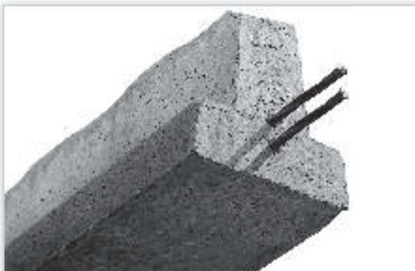
RECTOR, Belki 110-130. Materiał: beton C50/60. Zbrojenie: stal klasy 2060 MPa. Wymiary (dł./wys./szer.) [mm]: 1-10/110-130/98-105. Rozstaw osiowy [mm]: od 59 do 60.
