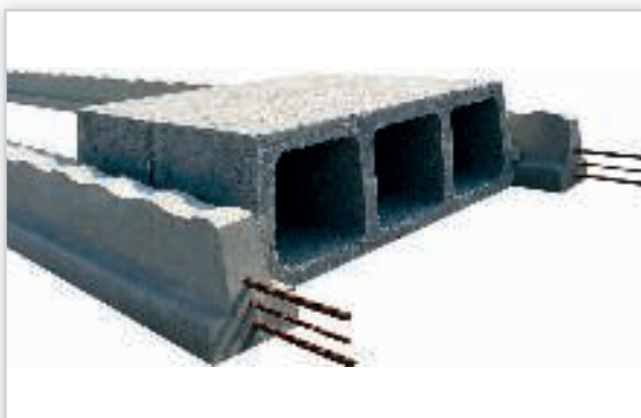
RECTOR, Rectobeton – wypełnienie pustaki z czystego betonu. Wysokość całkowita stropu [cm]: od 14 do 340. Masa: 1 m 2 stropu od 235 kg. Klasyfikacja ogniowa: od REI 60 do REI 240. Stosowany we wszystkich rodzajach budynków, na wszystkich kondygnacjach uzupełnieniem systemu są: zbrojenia przypodporowe, zgrzewane maty siatki stalowej oraz beton monolityczny wylewany na budowie.
